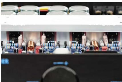
Tranzystory wyjściowe to współczesne elementy firmy ST Microelectronics.
